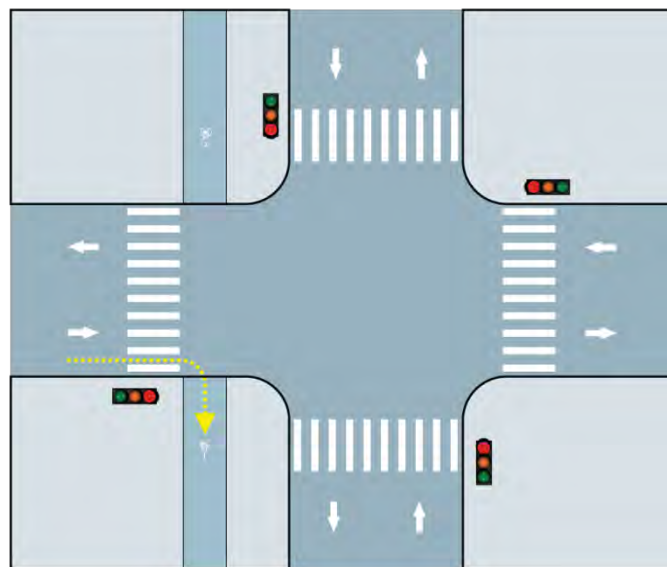
Figura 71. Situație în care măsura "Permis pe culoarea roșie" poate fi pusă în aplicare fără prea multe dificultăți
